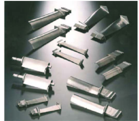
Las palas de turbina forjadas son acabadas mediante diferentes procesos de vibración a fuerza centrífuga y de granallado.
