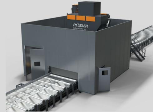
Je nach Ausführung der Anlage und Anzahl der Turbinen kann der Schallpegel wie bei Strahlanlagen üblich über  $80\text{ db(A)}$  steigen. Die Schalldämmkabinen bestehen aus hochwertigen, doppelwandigen Elementen mit Innenfutter, die so berechnet werden, dass der gewünschte Schallpegel garantiert werden kann. Rösler Schalldämmkabinen werden, wo möglich, nur um die lärmintensivsten Bauteile gebaut. Das hält die Kosten übersichtlich und die Effizienz wird nicht gemindert.
