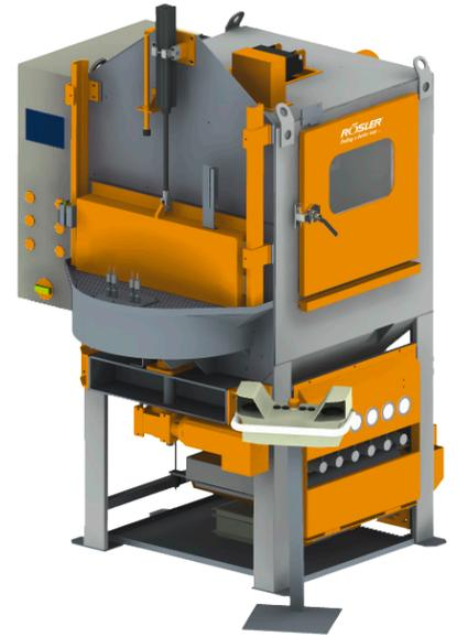
Die Wendetischanlage lässt sich nahtlos und prozesssicher in eine Fertigungsinsel integrieren. Zum Beispiel dort, wo in einer oder mehreren Spritzgießmaschinen oder Pressen unterschiedliche Werkstücke hergestellt werden, die im Anschluss an die Fertigung automatisch entgratet werden müssen.
